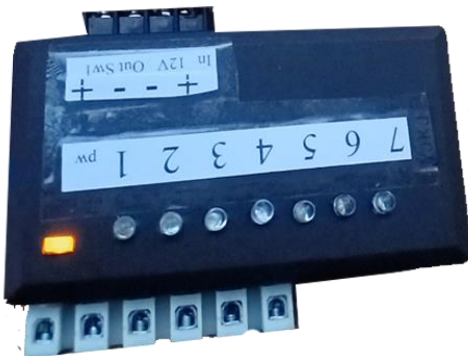
รูปที่ 5 กล่องควบคุม IoT ของพยอมแอปพลิเคชัน
